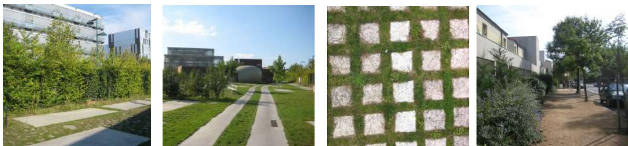
*Exemples illustratifs : graviers, dallage de bois, stabilisé ou terre armée, pavés drainant ou à joints engazonnés, bande de roulement.*
