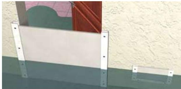
La stabilité des murs en maçonnerie de qualité courante peut être menacée dès lors que la différence de hauteur d'eau entre l'intérieur et l'extérieur atteint un mètre. Ceci conduit à limiter la hauteur des batardeaux à un mètre.
